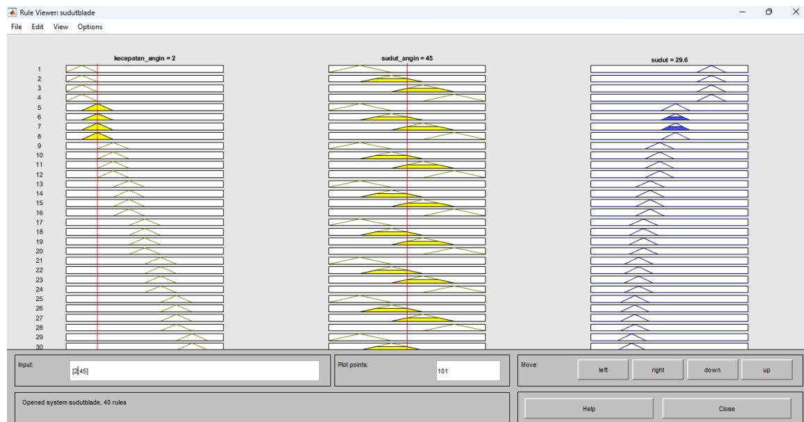
Gambar 5. Nilai FIS Parameter Sudut Pitch dengan Kecepatan Angin 2 m/s
